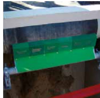
Барабанный скребковый сбрасыватель из полиуретана (PU)
