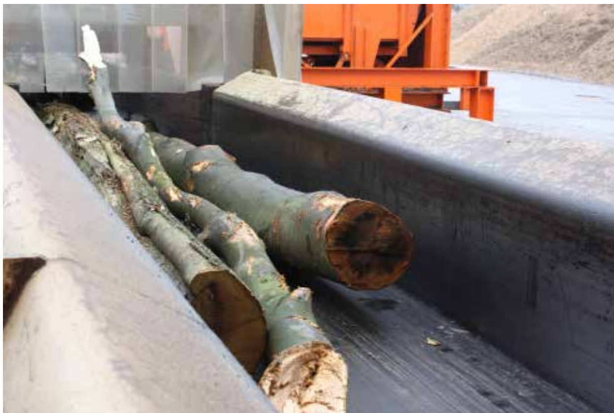
Использование скользкой конвейерной ленты
