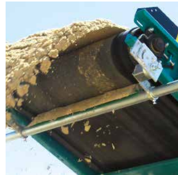
Скребокый сбрасыватель нижней ветви конвейера из твердых сплавов
